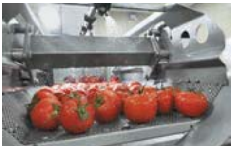
Рис. 7.19. Водная моечная установка для овощей и фруктов
