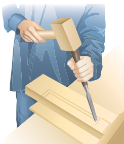
Рис. 4.54. Приём долбления на подкладной доске
