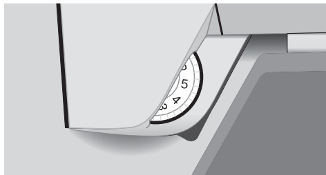
Рис. 6.13. Регуляторы натяжения верхней нити швейной машины
