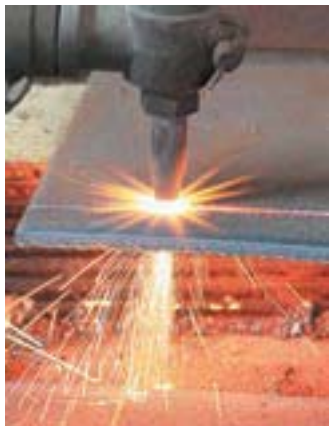
Рис. 2.1. Газовая резка металла
