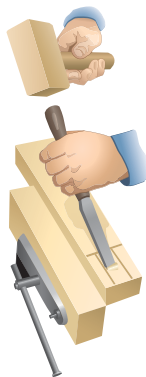
Рис. 4.55. Приём долбления в зажиме верстака
