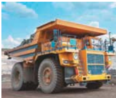
Рис. 3.1. Карьерный самосвал грузоподъёмностью 610 т
