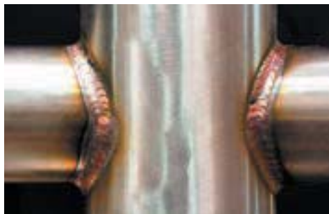
Рис. 2.9. Соединение труб дуговой сваркой
