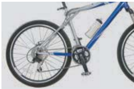
Рис. 3.5. Цепная передача в велосипеде
