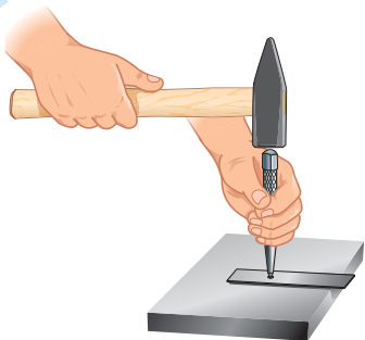
Рис. 5.21. Приём разрубания полосового металла на плите
