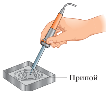
Рис. 5.61. Подготовка рабочей части паяльника (лужение)
