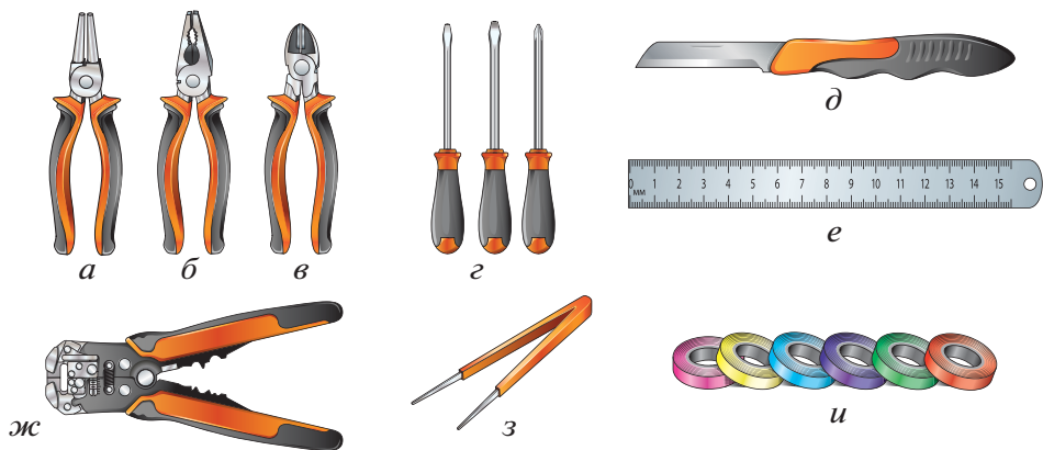
Рис. 11.1. Электромонтажные инструменты и изоляционные материалы: а — круглогубцы; б — пассатижи; в — бокорезы; г — отвёртки; д — нож электрика; е — слесарная линейка; ж — приспособление для снятия изоляции; з — пинцет монтажный; и — изоляционные ленты
