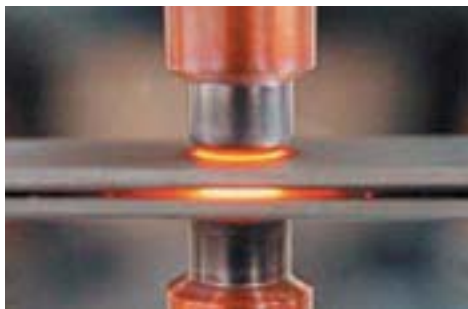
Рис. 2.10. Процесс контактной электросварки
