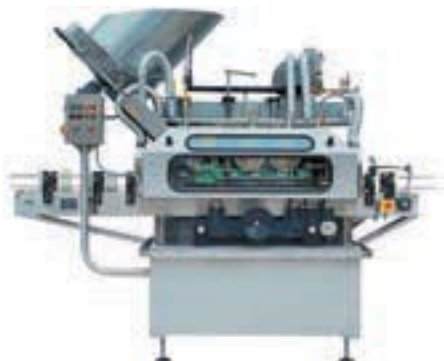
Рис. 7.20. Автомат вакуум-укупорочный типа «ТВИСТ-ОФФ»
