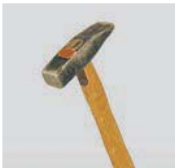
Рис. 5.41. Крепление фиксатора в ручке слесарного молотка
