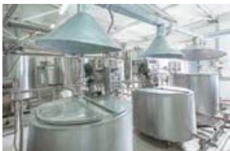
Рис. 7.9. Оборудование для пастеризации молока
