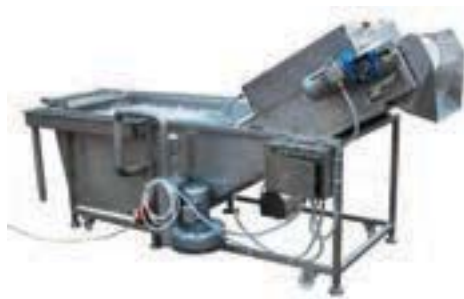
Рис. 7.19. Водная моечная установка для овощей и фруктов
