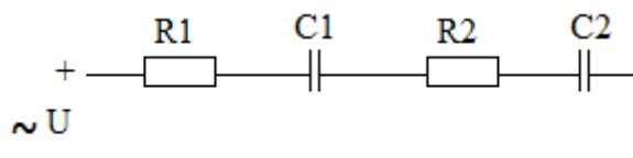
11. Начертить векторную диаграмму для схемы  $R_1 = 4 \text{ Ом}$ ,  $R_2 = 5 \text{ Ом}$ ,  $X_{C1} = 10 \text{ Ом}$ ,  $X_{C2} = 8 \text{ Ом}$
