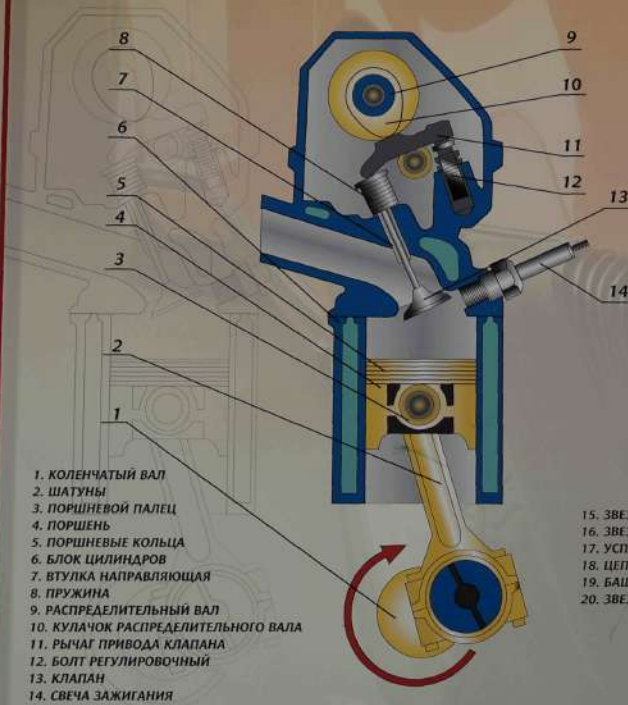
СХЕМА ДЕЙСТВИЯ МЕХАНИЗМА ГАЗОРАСПРЕДЕЛЕНИЯ
