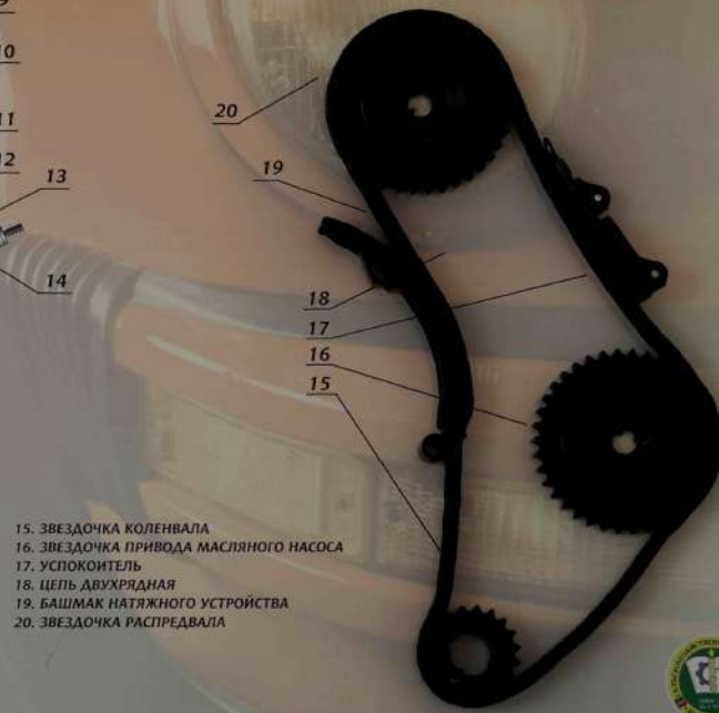
ПРИВОД РАСПРЕДЕЛИТЕЛЬНОГО ВАЛА
