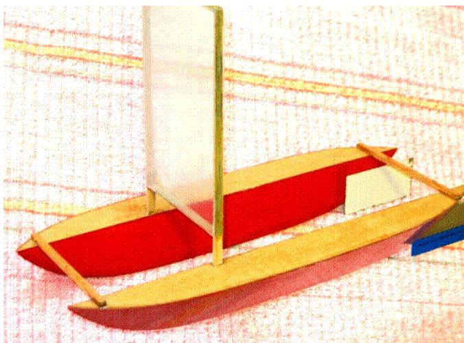
Катамаран с парусом. Корпуса изготовлены из электрокартона и покрыты эпоксидной смолой с прогревом, + цветной скотч. Размеры корпусов (д.ш.в., без рулей) –  $290 \times 30 \times 37$  мм. Расстояние между корпусами – 70 мм, связка корпусов сосновыми рейками  $4 \times 4$  мм. Парус –  $80 \times 130$  мм, рули –  $60 \times 30$  мм.
