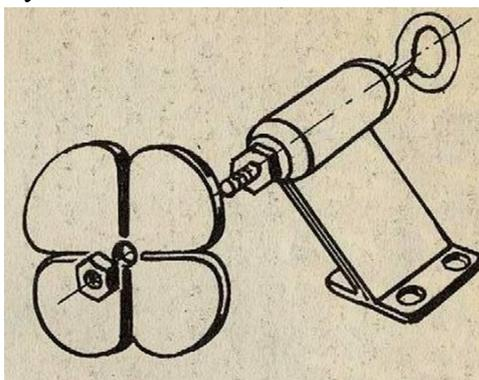
Следующий этап – сборка валов, кронштейнов и гребных винтов. После контроля точности и легкости вращения, гайки М4 и гребные винты пролить по стыкам расплавленным припоем. Лопасти аккуратно развернуть на угол атаки примерно 15 градусов и дополнительно формовать (выпуклость д.б. направлена вперед при стрелке прогиба профиля до 4мм). При этом не нужно забывать, что на двухмоторных моделях один винт правого, а другой – левого вращения.
