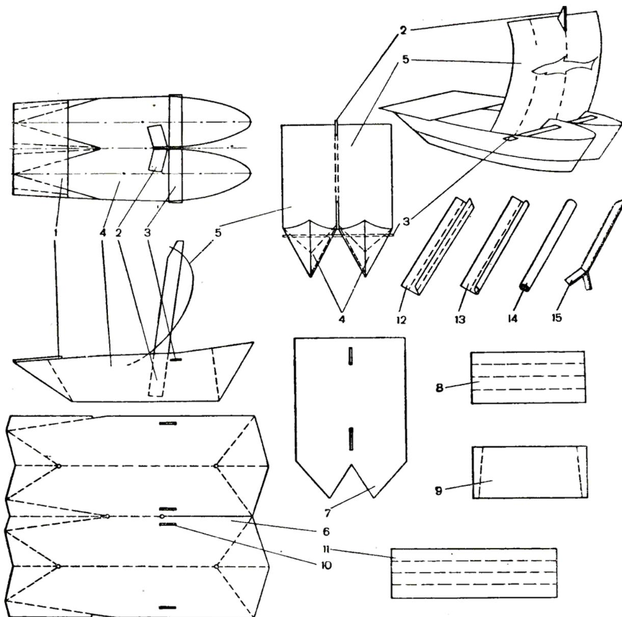
Детали бумажного катамарана: 1 — палуба кормы; 2 — мачта; 3 — соединительная планка корпусов; 4 — корпуса; 5 — парус; 6 — выкройка корпусов; 7 — выкройка паруса; 8 — выкройка соединительной планки корпусов; 9 — выкройка кормовой палубы; 10 — отверстие в корпусах для соединительной планки; — операции изготовления мачты.
