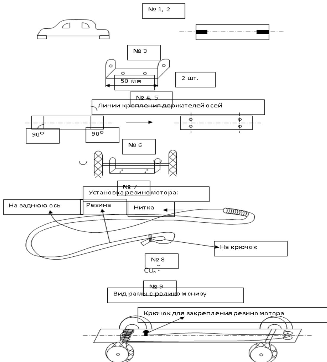
Установка резиномотора: резиномотор представляет собой кусок резинового жгута диаметром 1,5-2,5 мм, длиной - 1,5 длины корпуса, к которому привязана крепкая капроновая нить. Для его достаточного растяжения на шасси (раму) устанавливают ролики: один или два. Для того чтобы модель проехала 12 м, достаточно одного ролика, установленного перед передней осью.
