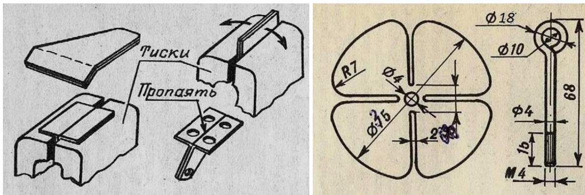
На листовой латуни толщиной около 1мм разметить заготовку гребного винта; после вырезки и правки, деталь зачистить наждачной бумагой. Из стальной проволоки диаметром 4мм и длиной 95мм сделать гребные валы. Для этого на одном из концов проволоки согнуть кольцо, а на другом нарезать резьбу М4.
