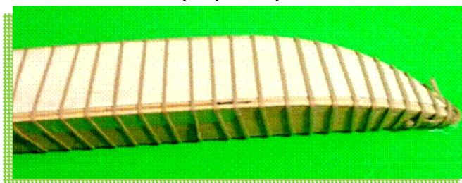
После полного высыхания, припуски убрать ножницами или ножом, довести шкуркой. Второй – полностью идентичен. Можно изготовить и цельно пенопластовые корпуса, обработав их в оправке ножом и шкуркой. Для прочности, гладкости и декора, поверхности заармировать скотчем.
